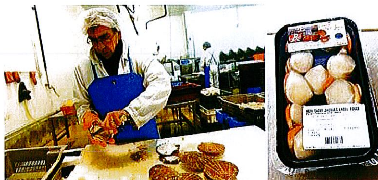
Conditionnées en barquettes sous atmosphère protectrice, la date limite de consommation des noix se prolonge jusqu'à 7 jours.
